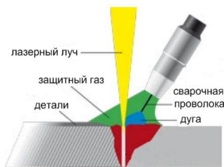
Рисунок 1 – Схема лазерно-дуговой сварки.
