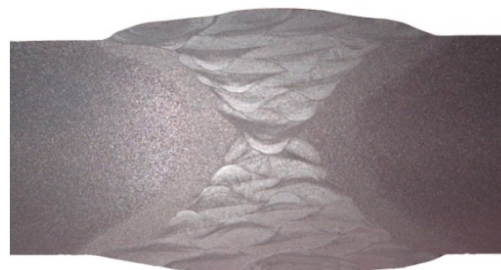
Рисунок 49 – Схема расположения границы сплавления крайнего валика с поверхностью основного металла от линии разделки свариваемой кромки (а) и макроструктура сварного соединения сплава марки 1550 толщиной 40 мм (б), где S – толщина свариваемых деталей.
